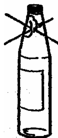
Рис. 17 Нанесение штриховых кодов на этикетку, размещенную на горлышке бутылки, не рекомендуется
